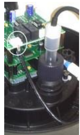
Afbeelding 47 - Aansluiting van de sonde
