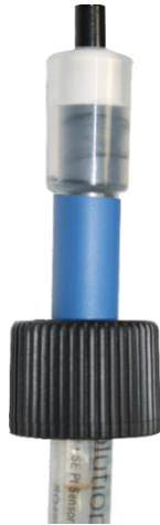
Afbeelding 48 - Aansluiting van de sonde SO4902
