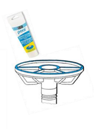
Afbeelding 9 - Smering van de afdichting en de klep
