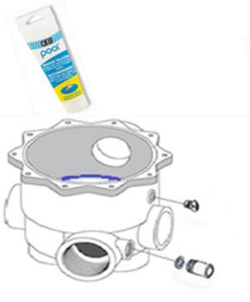
Afbeelding 9 - Smering van de afdichting en de klep
