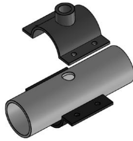
Afbeelding 76 - Boorgat Ø 20 mm (3/4'')
