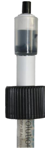
Afbeelding 49 - Aansluiting van de sonde SO4903
